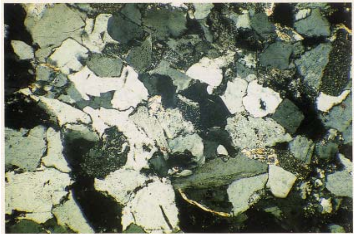
▲照片 8-5, 146K 畢祿山層變質砂岩。成份以石英為主，石英顆粒為角狀或次圓狀，鑲嵌在一起，此為其岩力強度大過 52Mpa，甚至可高達 174.8Mpa 的緣故。
