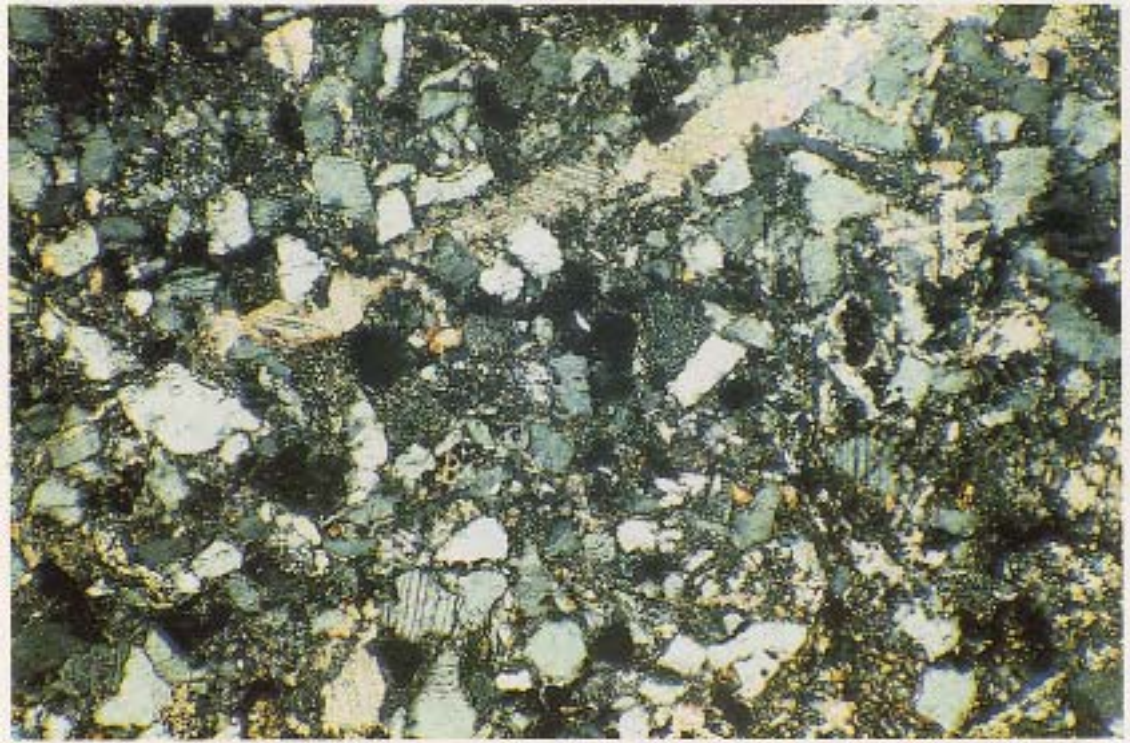
▲照片 8-1，128K 禮觀層砂岩。中至細顆粒，仍保有沈積岩之構造，成份為石英，長石與不透明礦物等。(open)
