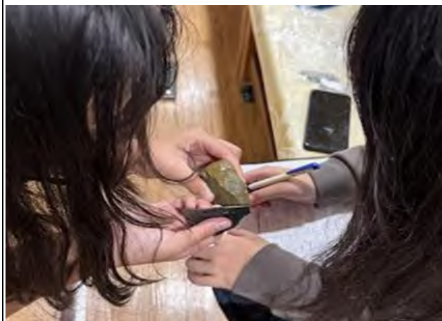
透過岩石互刮結果找出蒐集石塊硬度
