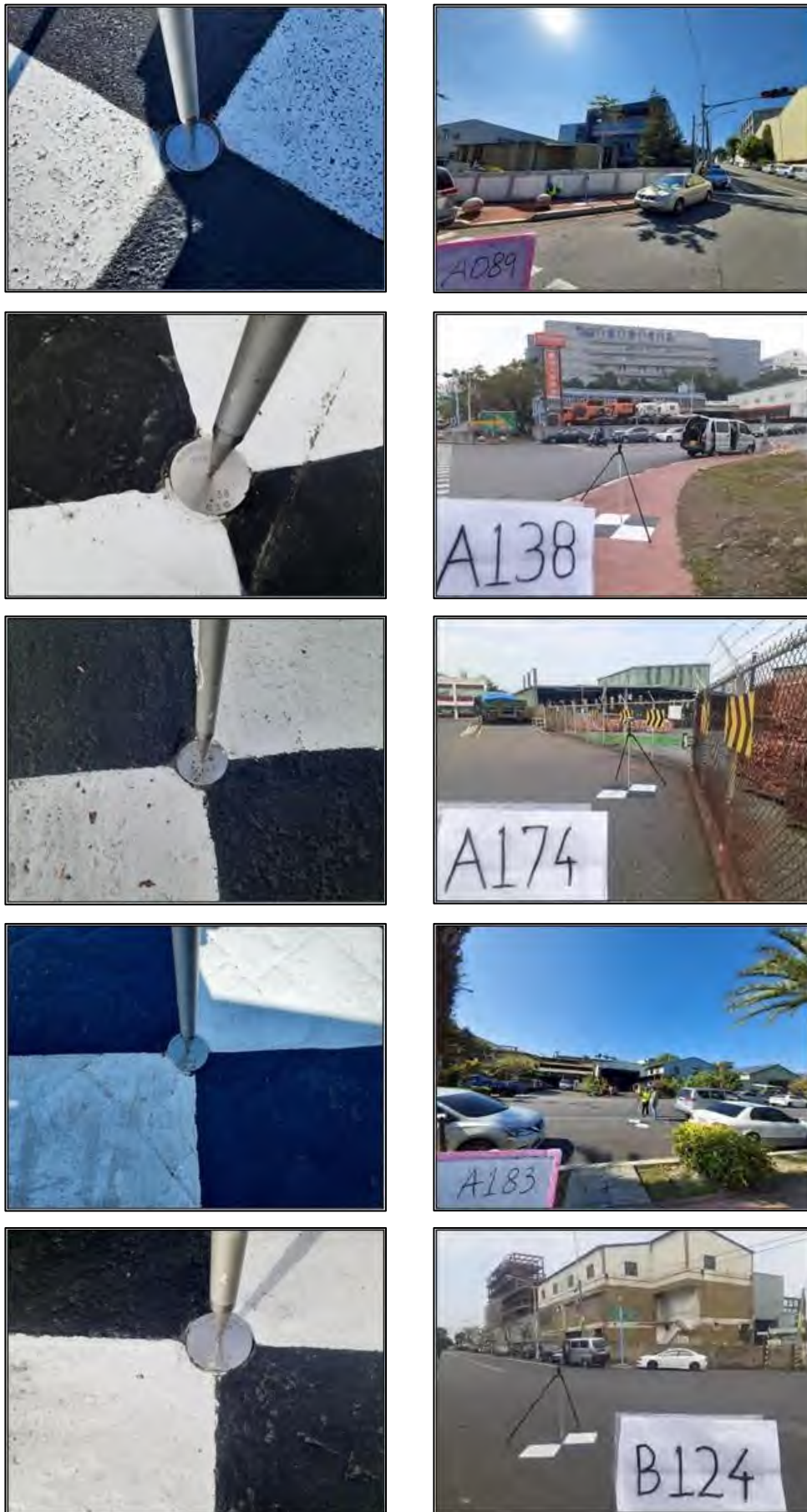
圖 4-5 南崗率定場地地面高程檢核點施測作業照
