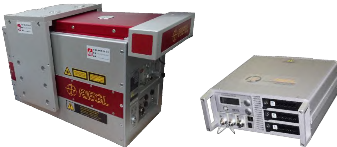
圖 1-1 Riegl LMS-Q780 空載光達掃瞄儀+DR680 儲存設備實機照
