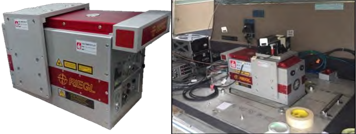
圖 2-3 空載光達 Riegl LMS-Q780 實機照
