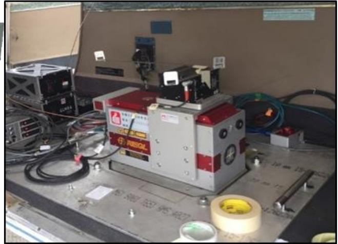
圖 2-3 空載光達 Riegl LMS-Q780 實機照
