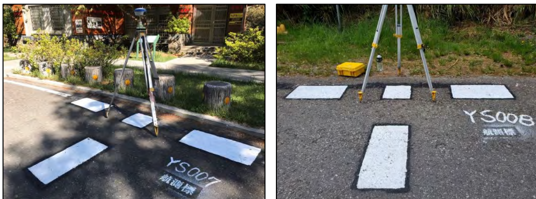
圖 2-22 航測標現地標註照片
