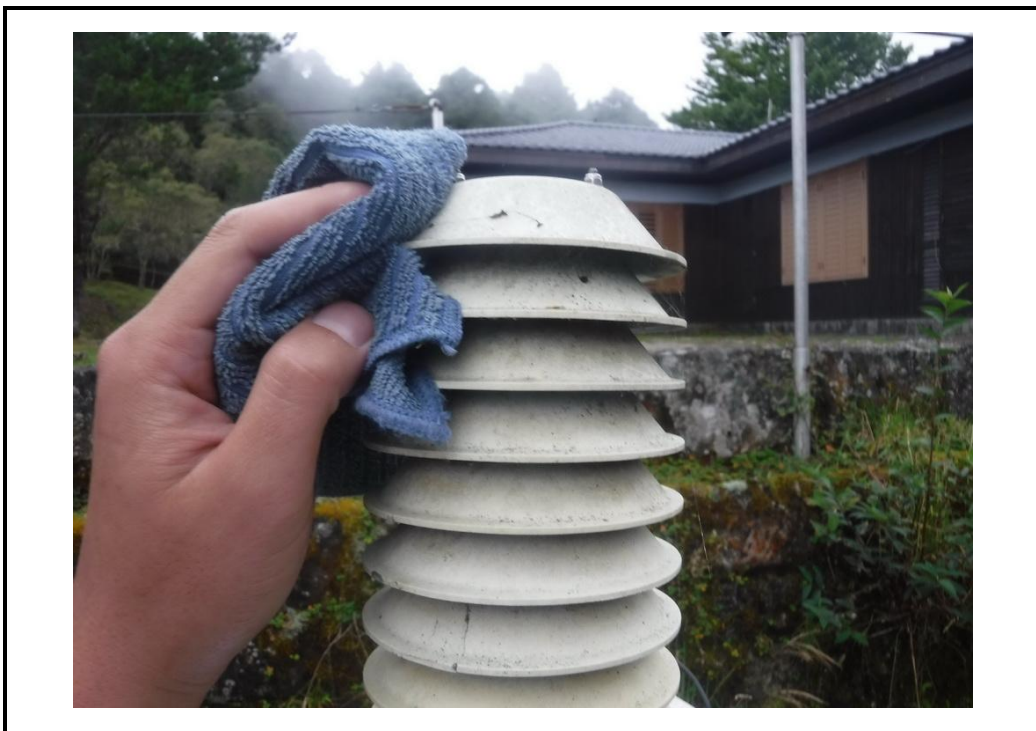
圖 2：塔塔加站溫濕度計輻射罩清潔中
