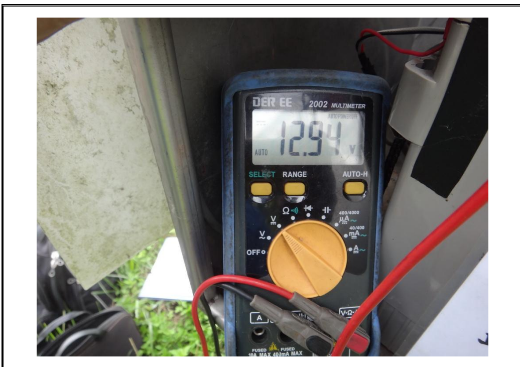
圖 10：梅山站電池電壓量測
