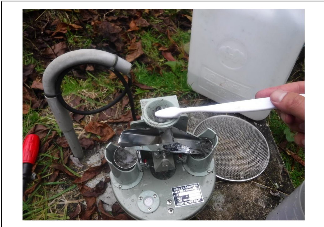
圖 5：塔塔加站清潔雨量筒
