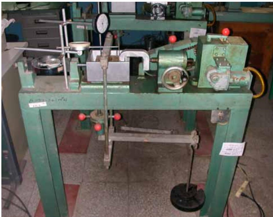
圖 5-2 土壤直接剪力試驗儀
