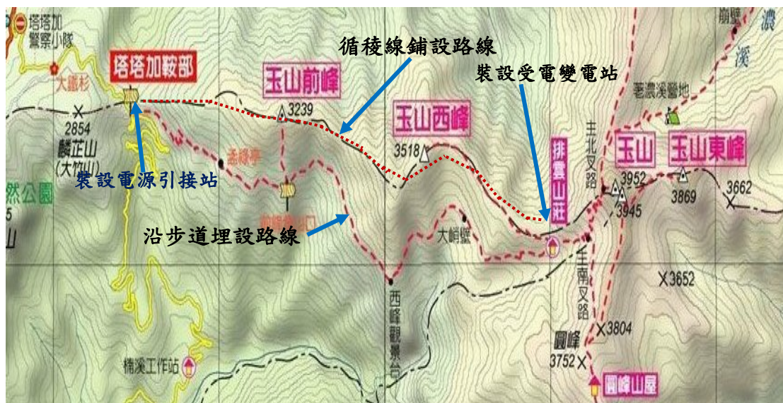
塔塔加鞍部至排雲山莊段鋪設市電必要之設施
