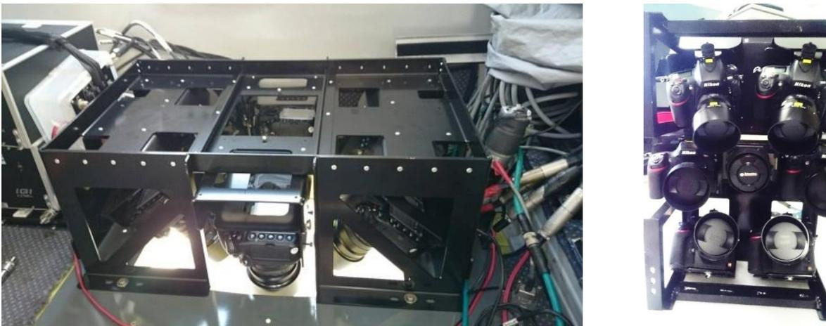
圖3-13 傾斜像機 AOS-7 實機安裝照片圖
